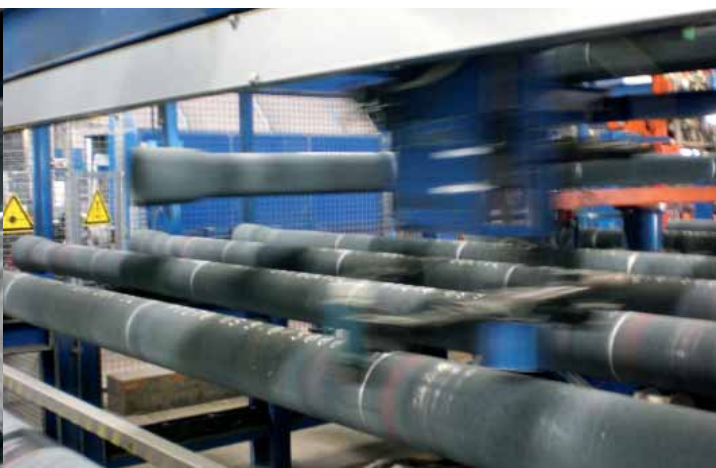
Průběžná kontrola kvality každé jednotlivé pilotové trouby
