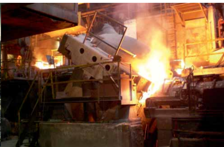
Výroba pilot z litého železa odstředivým litím
